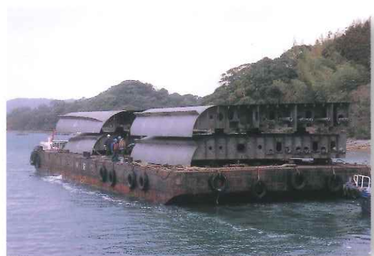
船体二重底ブロック
